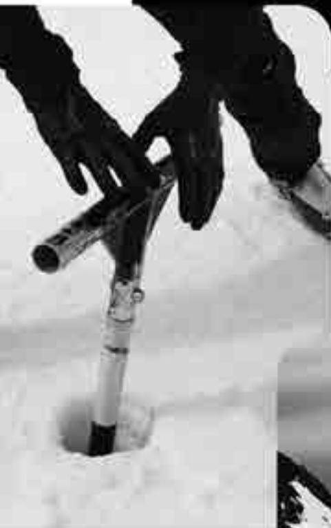
Carottage et mesure de l'accumulation
